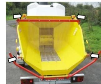
11) **Mise hors service :** Laisser le broyeur se vider pendant quelques minutes pour bien éliminer les résidus de matières devant le rouleau ameneur et dans le corps de broyage.
