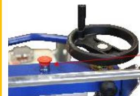
Pour un arrêt d'urgence utiliser l'interrupteur coup de poing rouge situé à côté du volant de réglage de profondeur.
